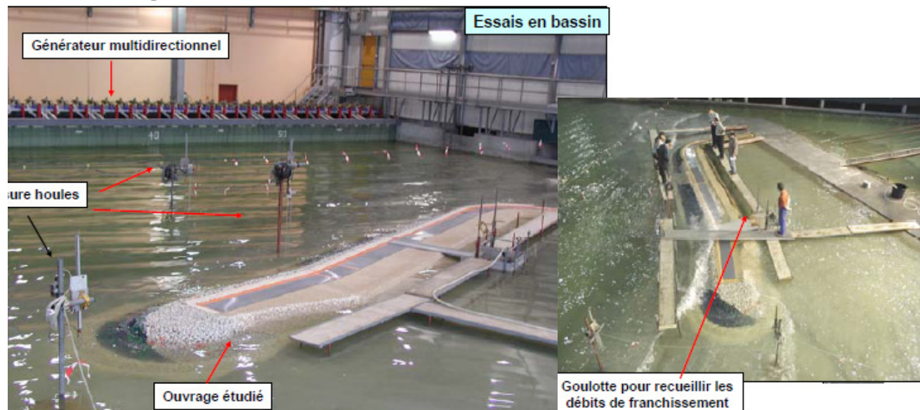
Figures IV.4 : Essais cuve à houles avec mesure de houles et de franchissement
