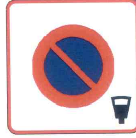
370.4 Entrée d'une zone à stationnement payant
