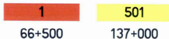
Borne 24 (exemples) Plaquette de repérage des points remarquables utilisées sur le réseau routier classé
