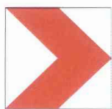
916 (exemples) Barrière : signal de position d'une déviation ou d'un rétrécissement temporaire de chaussée
