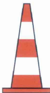
914 Dispositif conique : signalisation de position des limites d'obstacles temporaires ou de chantier
